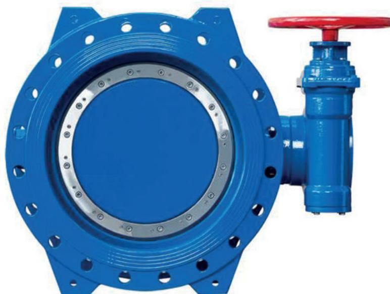
Kelebek vana bağlantı şekli olarak çift flanş bağlantı yüzeyine sahiptir. Yataklama şekline göre çift eksantrik (Eksenden kaçık) dizayna sahiptir. Basıktır cemberi ile klepeye takılan elastomer sit sayesinde tam sızdırmazlık sağlar.
