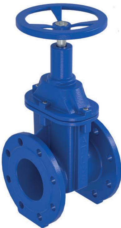
Sürgülü vana tam açık ya da tam kapalı olarak kullanılmak üzere dizayn edilmiştir. Sonsuz dişli mil üzerine monte edilen sürgü, volan saat yönünde döndürülerek açılır, saat yönünün tersinde döndürülecek kapatılır.
